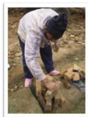
Imagine 14. Cărămidar Curcani, explicând procesul de așezare a cărămizilor la uscat.
